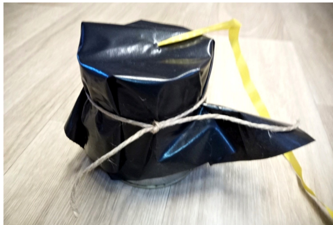
Membránu položíme na otvor v plechovce, přehneme okraje a přichytíme provizorně provázkem. Stužka bude ve středu.
